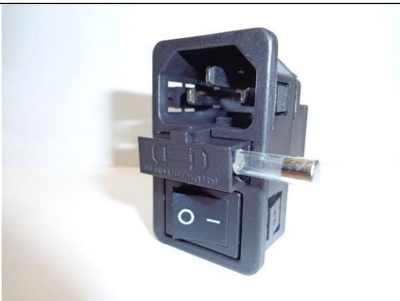
L'interrupteur général situé derrière le poêle possède un porte fusible. Il faut tirer sur le tiroir dans lequel le fusible est placé afin de le contrôler. Il y a un deuxième fusible de secours dans ce tiroir Le calibre de ce fusible est de 3A.
