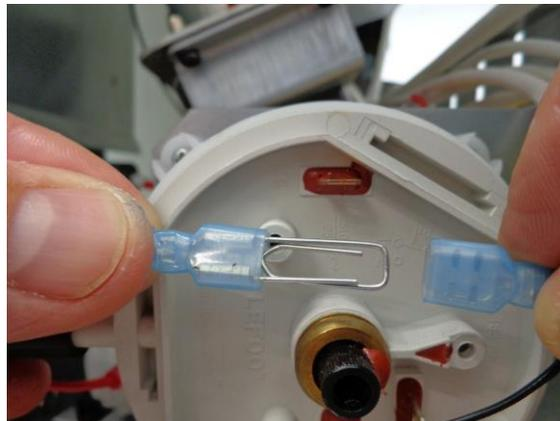
Débranchez les deux cosses bleues et reliez les ensemble à l'aide d'un trombone si vous n'avez pas de fil électrique. Faites une bonne connexion de manière à ce qu'il ny ait pas de faux contacts. Le « V » devra alors apparaitre en permanence dans l'écran, **que le poêle soit en marche ou à l'arrêt.**
