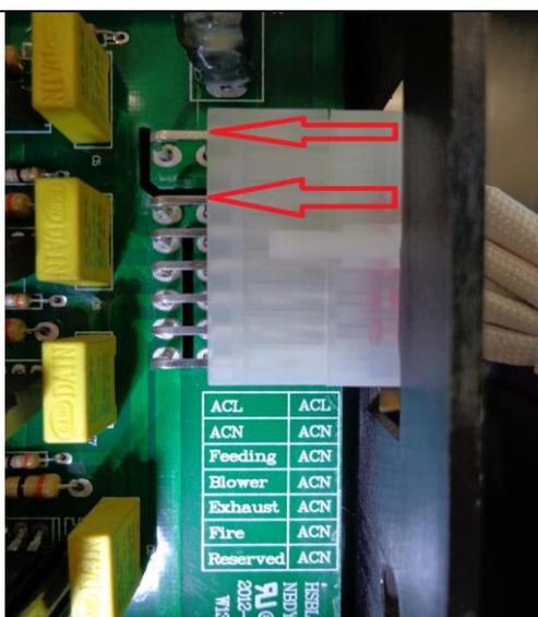
Contrôlez que le courant arrive bien jusqu'au boîtier de puissance. Positionnez un voltmètre sur les broches désignées par les flèches rouges et qui correspondent aux repérages ACL / ACN. Si le courant arrive bien à l'entrée du boîtier de puissance le voltmètre devra indiquer 220 V alternatif.
