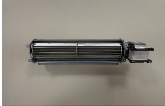
Contrôlez que ce moteur ne soit pas bloqué, en poussant la turbine avec un doigt, celui-ci doit faire plusieurs tours et ne montrer aucune résistance.
