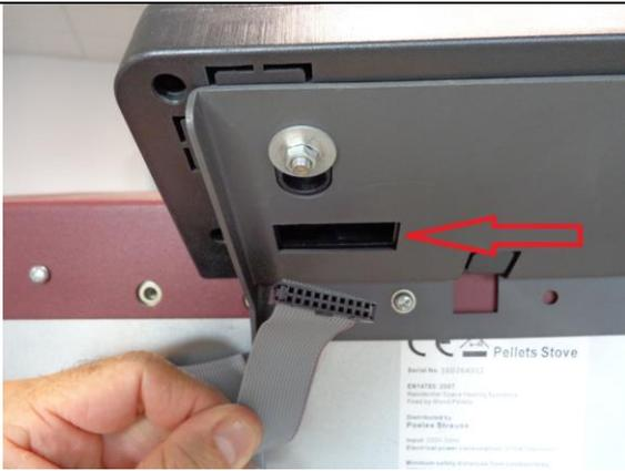
Contrôlez que le câble plat et gris qui se connecte derrière le tableau de commande ne soit pas mal embroché ou endommagé à un endroit ou à un autre.
