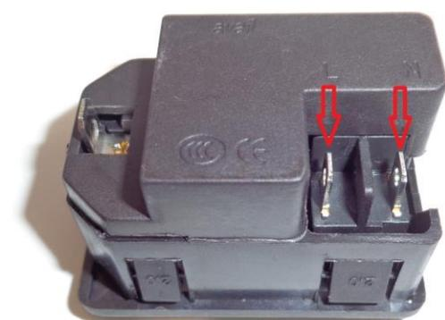
Contrôlez l'interrupteur général : après avoir débranché les deux cosses bleu et rouge, mesurez à l'aide d'un voltmètre que l'alimentation secteur 220v traverse bien celui-ci lorsqu'il est en position 1.
