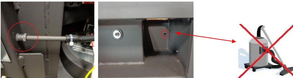
Photo 1 : écrou qui maintient le tuyau métallique qu'il faut contrôler et resserrer le cas échéant.
