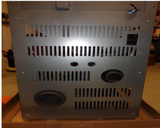
Vis de fixation de la plaque arrière
