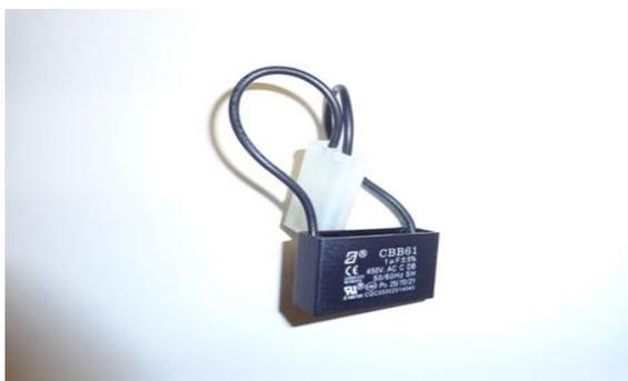
Condensateur qui est relié au connecteur blanc du moteur de vis sans fin. Ce condensateur est destiné à donner de la force au moteur (voir contrôle à effectuer ci-dessous) Capacitor that is connected to the white connector of the worm engine. This capacitor is intended to give strength to the engine (see control to perform below)
